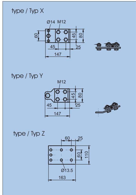
Variants of installation and drilling plan / Aufstellvarianten und Bohrplan
