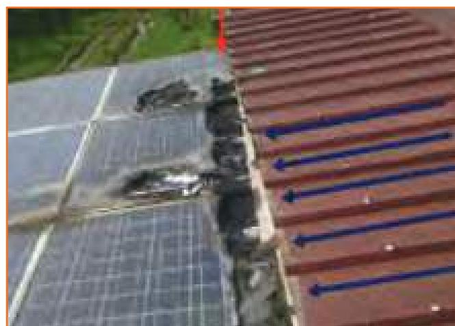
Fig. 8 - La posizione dei moduli ha favorito l'ingresso dell'acqua all'interno dei moduli stessi con conseguente innescio dell'arco elettrico e successivo incendio.
