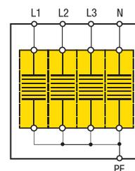
**IA 25 230 4 est un ensemble de quatre parafoudres de type coupure en tension, prêt au raccordement, fournissant quatre modes de protection, généralement installé à l'origine de l'installation (par exemple dans le TGBT) pour des systèmes triphasés et neutre 230/400 V TN. Il présente les caractéristiques et avantages suivants:**
